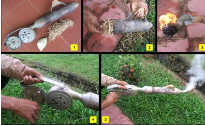
Gambar 36. Fumigator asap belerang (emposan). (1) Fumigator, jerami, dan bubu belerang; (2) Campuran jerami dan bubuk belerang dimasukkan ke dalam selongsong fumigator; (3) Jerami dinyalakan (dibakar); (4) Selongsong dipasang pada fumigator dan roda kipas diputar; (5) Fumigator siap digunakan untuk fumigasi lubang sarang tikus di tanah.
