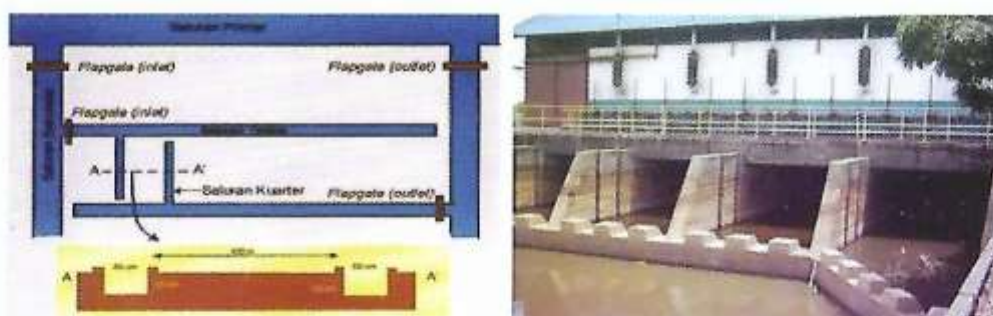
Gambar 17. Skema tata air tabat (kiri) dan mini pholder (kanan) di lahan lebak
