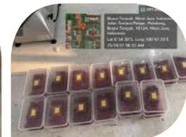
Prototipe Label Indikator untuk deteksi kesegaran daging
