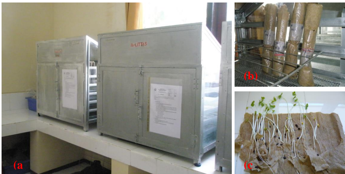
Gambar 5. (a) Germinator, (b) UKDdp disusun dalam germinator, (c) Kecambah yang siap diamati pada hari ke-8 setelah tanam
