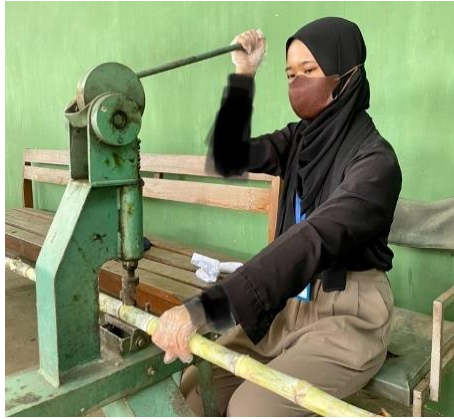
Lampiran 1. Dokumentasi Proses Pengambilan Mata Tunas Tebu Menggunakan Budchip Meja
