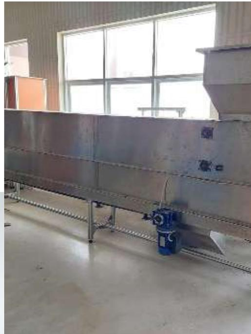
lampu yang memancarkan sinar ultraviolet. media tanam yang dapat diatur sehingga dapat digunakan untuk berbagai laju aliran media tanam yang bervariasi. Mesin ini digunakan untuk mensterilkan media tanam yang berupa tanah dengan kadar air. Mesin ini juga dapat melakukan pembalikan media tanam berlangsung secara otomatis.
