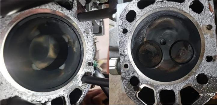
Gambar 40. Hasil jelaga pada silinder head dan torak/piston
