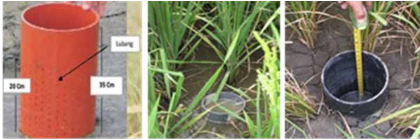
Gambar 1. Penggunaan pipa paralon untuk mengontrol ketinggian muka air tanah sawah pada penerapan irigasi basah kering
