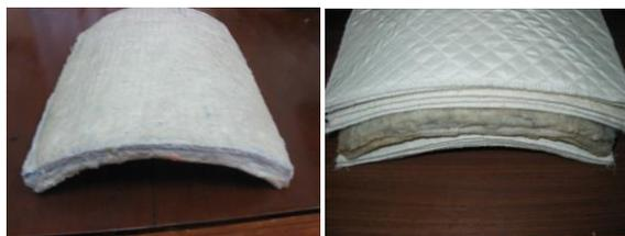
Gambar 9. Komposit rami untuk panel antipeluru dengan penguat kain poliester
