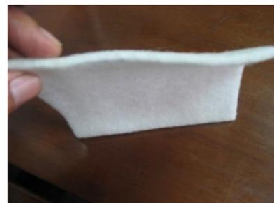
Gambar 6. Kain *non-woven* yang dibuat dengan mesin *needle punching*
