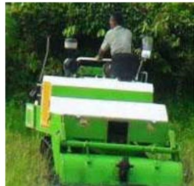
Mesin Pengolahan Tanah Amphibi merupakan hasil perekyasaan Balitbangtan (Patent dengan Nomor IDS000001646) yang berfungsi untuk mengolah tanah sekaligus mencacah sisa jerami padi, sisa tanaman jagung, dan gulma serta mencampur dengan tanah, untuk meningkatkan kandungan bahan organik tanah, yang dilengkapi dengan penyemprot dekomposer untuk mempercepat proses dekomposisi bio masa.
