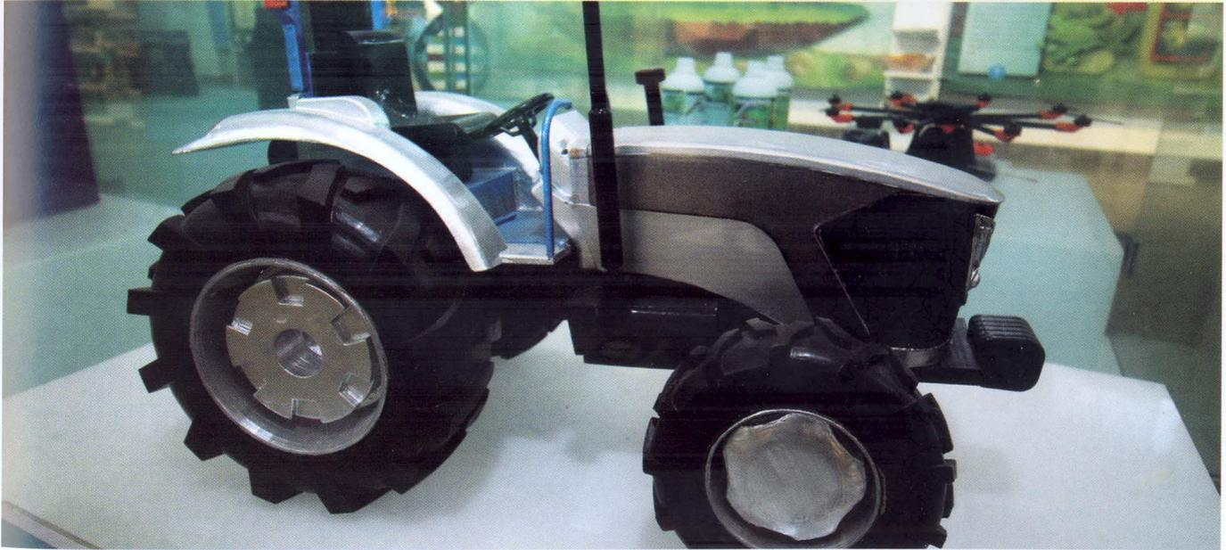
Traktor empat roda otonom ini menggunakan sistem navigasi dan GPS berbasis Real Time Kinematika (RTK). Keunggulan traktor tanpa awak ini mempunyai keunggulan dalam mengolah tanah dibandingkan Traktor Roda 4 yakni,
