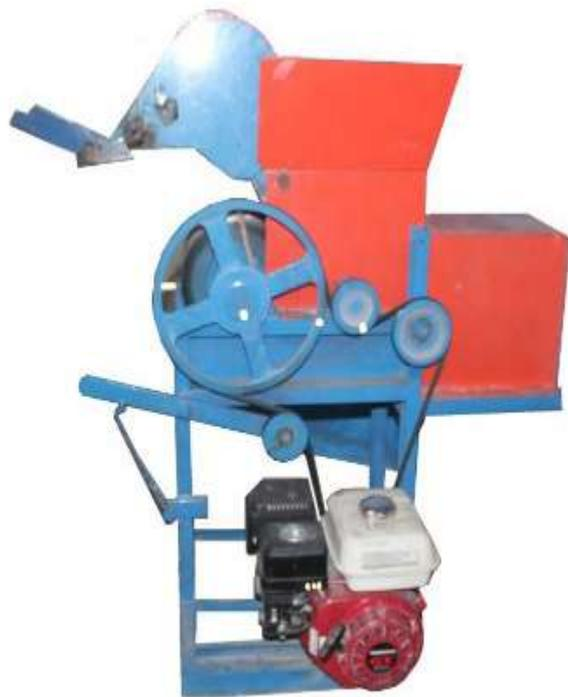
Permasalahan pada mesin pemisah serat dan biji kapas yang ada adalah kesulitan mengganti silinder *roll* apabila mengalami keausan. Inovasi ini dikembangkan dengan komponen silinder, pisau pemisah serat, dudukan, rangka, serta motor penggerak.
