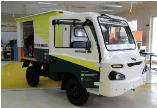
Sistem pelayanan Perangkat Bengkel Alat Mesin Pertanian Bergerak terdiri dari *genset*, alat las, kompresor, gerinda, dongkrak, *tool kit*, *spare part*, perangkat komputer, dan jaringan internet. Peralatan bengkel dihidupkan oleh listrik yang bersumber dari *genset* yang digerakkan oleh PTO (*Power Take*
