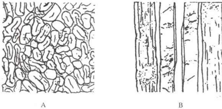
Gambar 3. Penampang melintang (A) dan membujur (B) serat rami hasil proses degumming (Jarman et al. , 1978)
