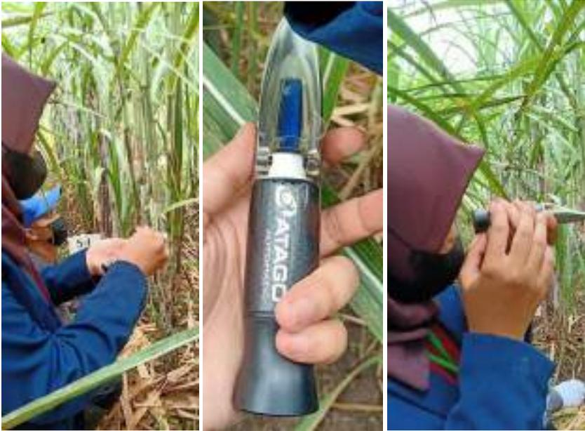
Mengukur *brix* pada tebu menggunakan alat Refraktometer
