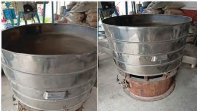
Gambar 16. Mesin pengayakan tepung porang.
