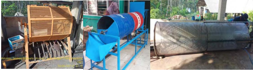
Gambar 12. Peralatan pencucian umbi porang segar.
