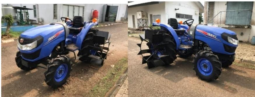
Gambar 9. Roda apung traktor roda empat
