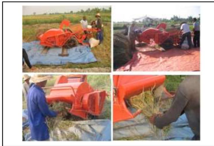
Gambar 6. Kegiatan menggunakan mesin secara "stationer" untuk kegiatan merontok saja
