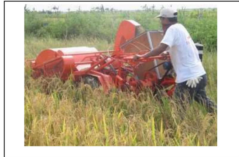
Gambar 1. Operasional Mesin penyisir padi di lapangan
