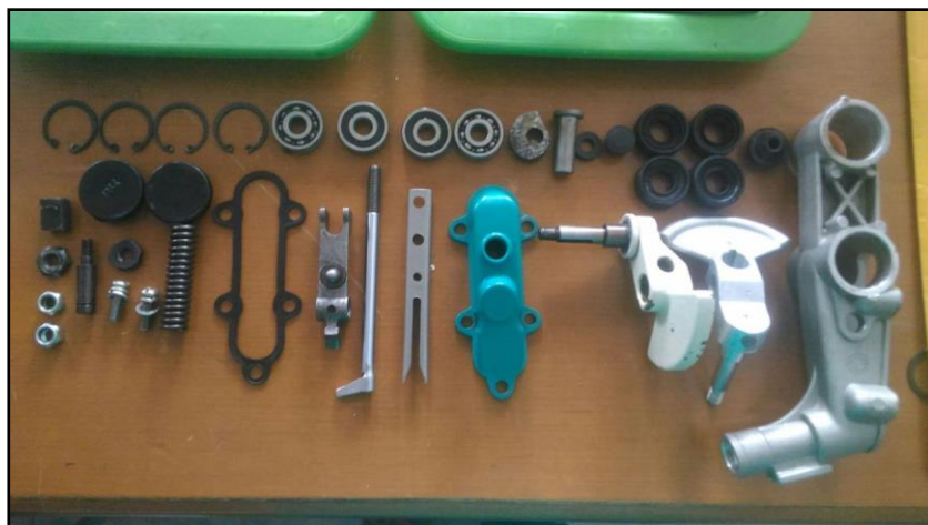
Gambar 6. Komponen-komponen Penyusun Finger Planting Mesin Rice Transplanter
