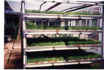
Berfungsi sebagai tempat pemeliharaan persemaian dengan metode penyiraman yang dilengkapi dengan sprinkler yang dioperasikan secara otomatis (waktu penyiraman dapat diatur menggunakan timer). Digerakkan oleh pompa air berkapasitas 40 L/menit. Berupa 5 tingkat rak yang dapat menampung 100 kotak bibit
