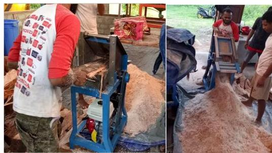
Gambar 2. Proses pamarutan empulur sagu dengan sistem tanpa pengupasan kulit batang
