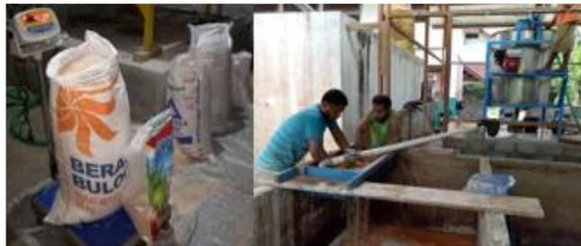
Gambar 4. Proses ekstraksi pati (kanan) dan hancuran empulur hasil parutan dimasukkan dalam karung plastik dan ditimbang sebanyak 155 kg untuk sekali proses
