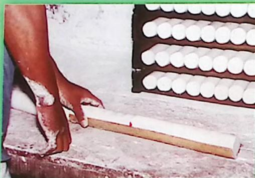
Proses pembuatan krupuk dengan cetakan belahan bambu
