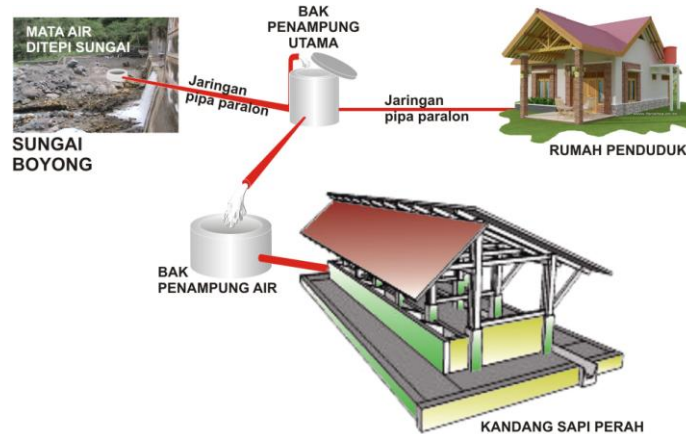
Gambar 1. Air disalurkan dari mata air ke bak penampung dan ke kandang sapi
